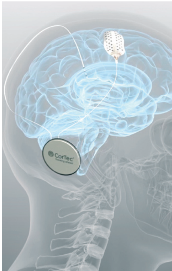
Eine Elektrode im Gehirn registriert neuronale Signalströme und leitet sie an eine Elektronikeinheit weiter, die hinter dem Ohr sitzt.
